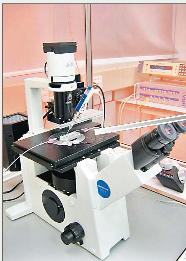
測試生物起搏細胞對不同電極反應的設施。
