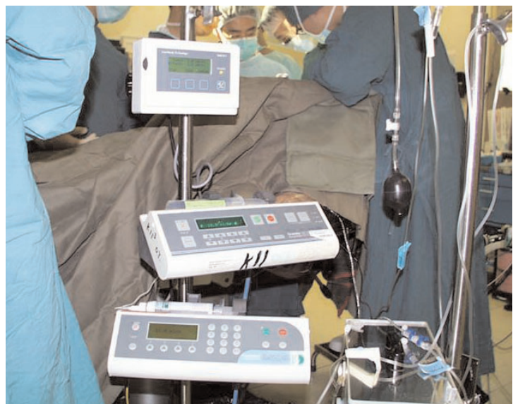
麻醉醫生會根據病人身體狀況，調節麻醉藥的用量。圖為電腦控制的麻醉藥注射儀器。
