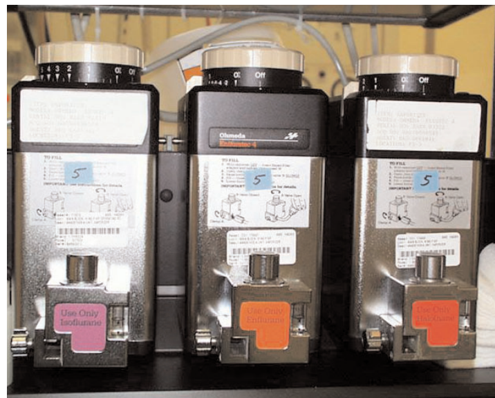
麻醉氣體蒸發器能準確控制病人吸入的藥物劑量。
